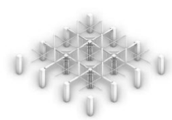
Fig. 12: A sinistra partendo dall'alto: aggiunta di carico sulla copertura della Sala Capitolare; colonne e pilastri della Sala; aggiunta delle cerchiature; aggiunta delle armature provvisorie di legname. (Elaborazione S. Accogli, A. Pizzo, R. Zilli)
